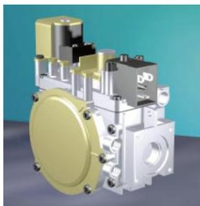
Controllo multifunzionale a doppia elettrovalvola con dispositivo pneumatico di regolazione proporzionale della portata di gas in funzione della portata d'aria, per apparecchi ad alto rendimento con circuito di combustione ventilato.
